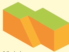
falla de desgarre
